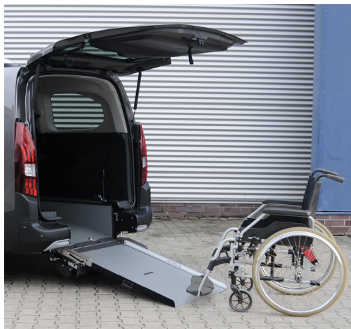
Bei ausgeklappter Rampe kann das Fahrzeug bequem mit dem Rollstuhl befahren werden.
